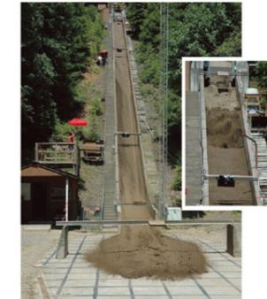
그림 5. 실 규모 토석류 시험 전경 (Iverson et al. 2011)
