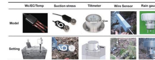
그림 2. 모니터링 센서의 설치개념
