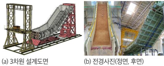
그림 3. 국립재난안전연구원 실규모 급경사지 붕괴재현 실증실험 장비
