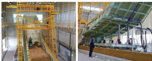
그림 4. 다기능 이송장치(워크플랫폼) 그림 5. 유압실린더
