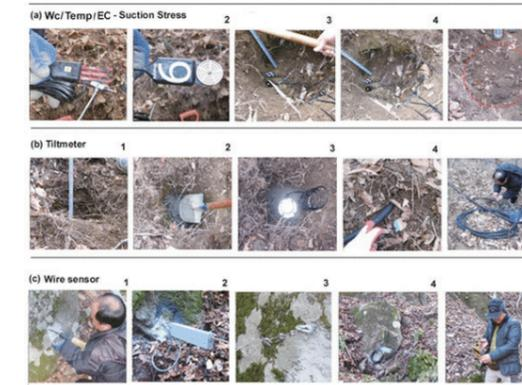
그림 3. 모니터링 센서의 설치방법
