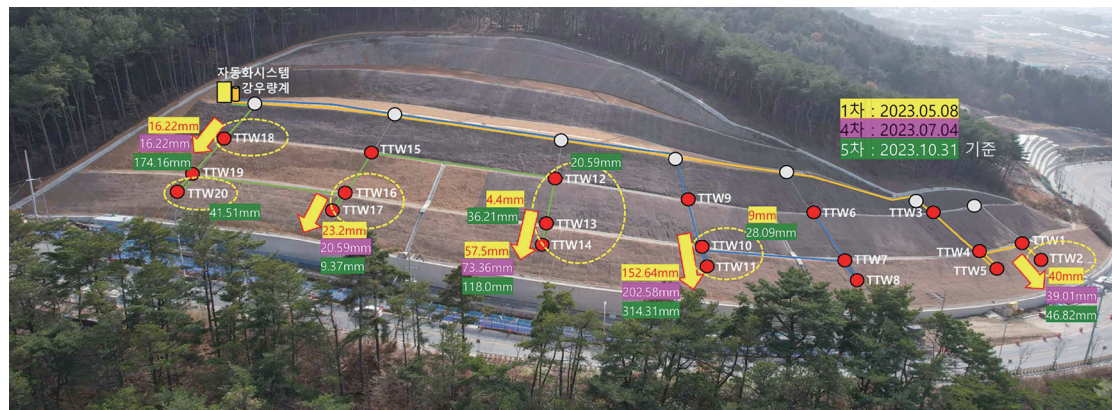
사진4. 2차 붕괴시 지표변위복합센서 위치별 이상 범위발생 계측 자료
